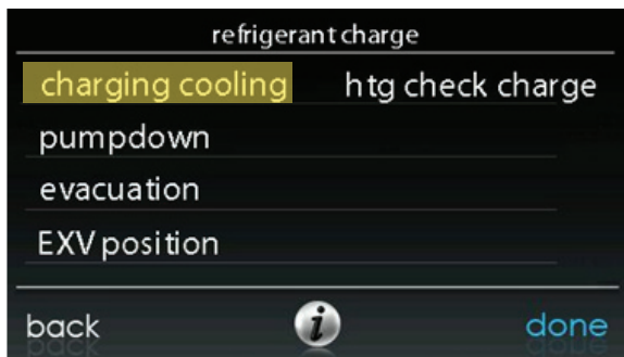
Figure 12 – Sélectionner la charge de sous-refroidissement
