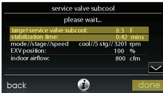
Figure 18 – Temps de stabilisation A14575
